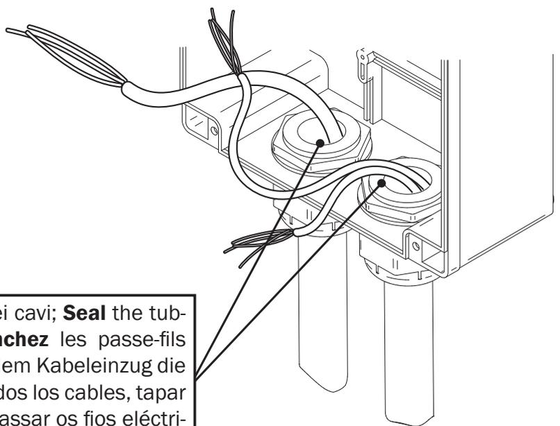
**Sigillare** le canalette dopo il passaggio dei cavi; **Seal** the tubing trays after installing the wires; **Étanchez** les passe-fils après que vous avez passé des fils; **Nach** dem Kabeleinzug die Rohröffnungen abdichten; **Una** vez colocados los cables, tapar las canaletas; **Tapar** os cabos depois de passar os fios eléctricos; **Zapieczerować** kanały po przejściu kabli; **Плотно** закрыть каналы после выполнения прохода кабелей.
